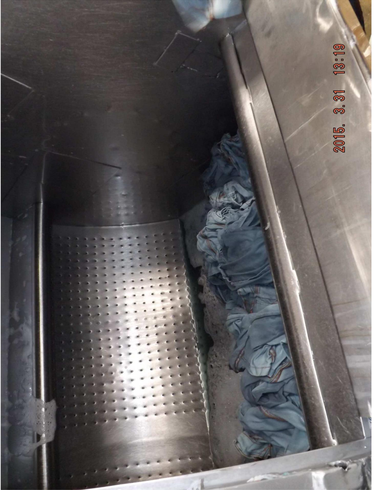
**Logo após, ocorre a estonagem, na qual o tecido sofre um desgaste por enzimas, que são facilitadoras do desbote, ou catalizadoras. Elas agem diretamente sobre a celulose do denim, o algodão. Existem três tipos de enzimas utilizadas nesse processo: as ácidas, neutras e híbridas.**
