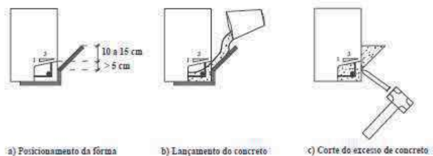
Figura 1 - Detalhe da forma tipo cachimbo
