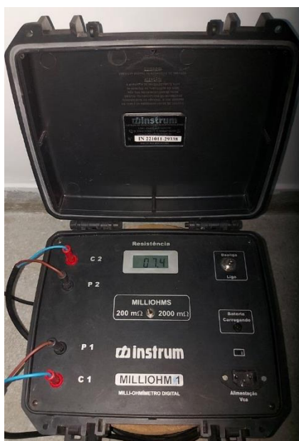
Figura 47 – Medição com o terrômetro da resistência de aterramento.
