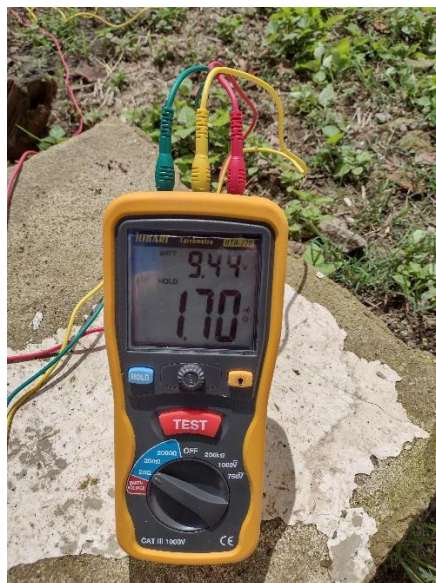
Figura 7 – Medição com o terrômetro da resistência de aterramento.
